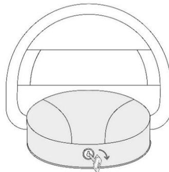
2. Sa donje strane uređaja se nalaze rupe za šrafljenje u podlogu. Izbušite tri rupe, ubacite metalne tiplove, kroz rupe na uređaju ušrafite
